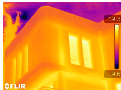
Figura 4.3 – Rilievo termografico della parete esterna con esposizione nord ovest
